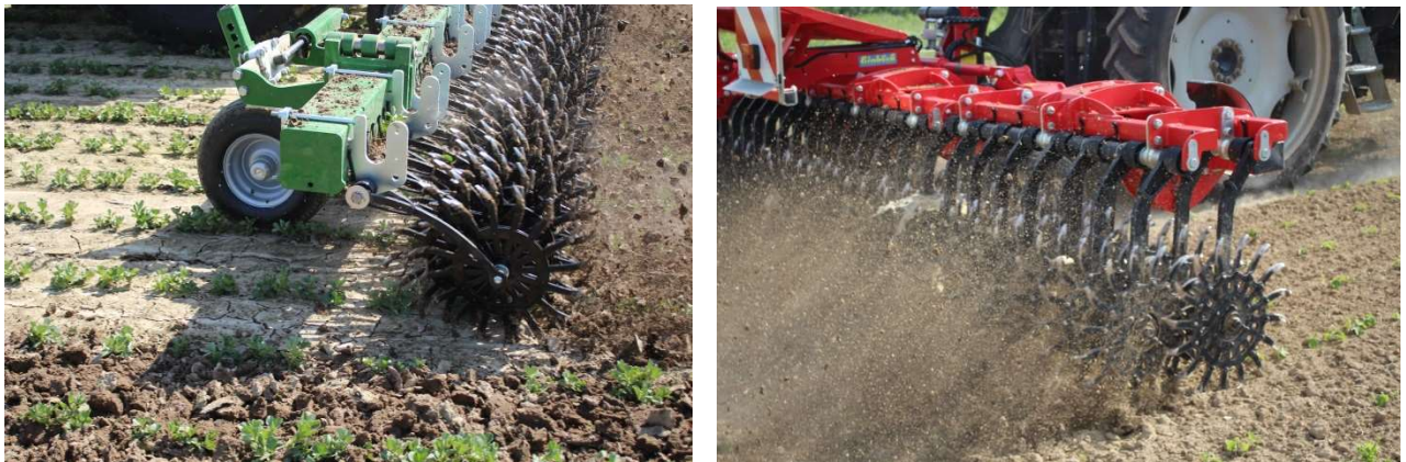
Abbildung 1: Die Rollsterne mit löffelförmigen Spitzen brechen Bodenkrusten auf und schleudern die Bodenteilchen in die Luft. (Bild rechts: Einsatz in Ackerbohnen, links: in Sojabohnen)
